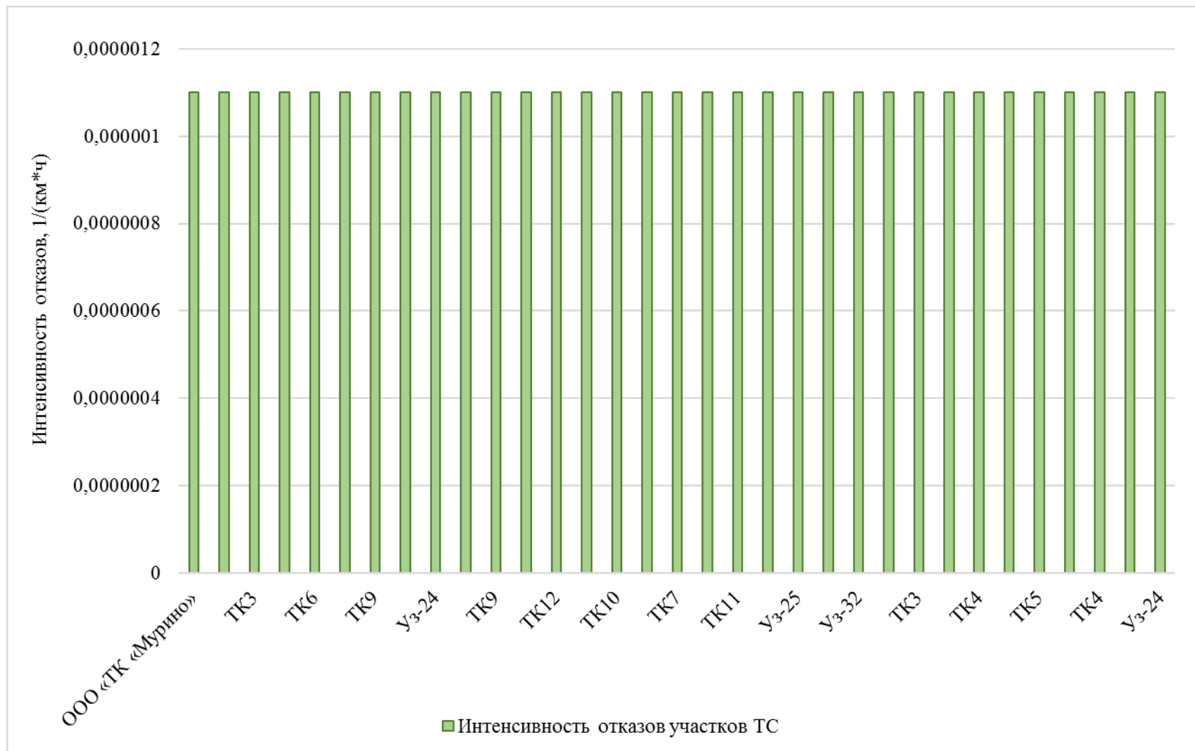
Рисунок 3. Вероятность отказа работоспособного состояния тепловой сети от котельной ООО «ТК «Мурино»
